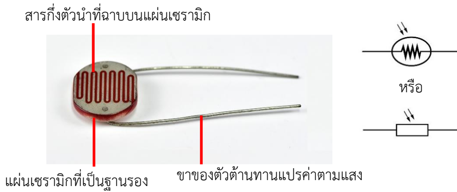
ภาพที่ 9 ตัวต้านทานแปรค่าตามแสงและสัญลักษณ์ในวงจรไฟฟ้า
