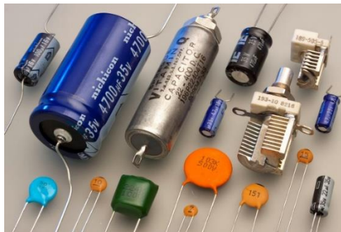
ที่มา : 1840368sharanyab ภาพที่ 1 ตัวเก็บประจุชนิดต่าง ๆ
