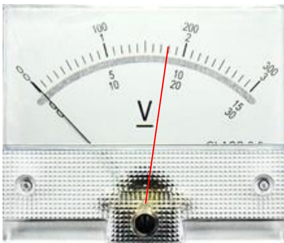
ภาพที่ 8 ภาพเข็มชี้บนหน้าปัดโวลต์มิเตอร์
