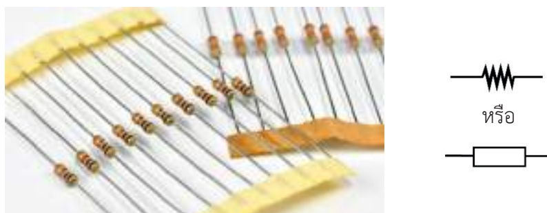
ภาพที่ 2 ตัวต้านทานคงที่และสัญลักษณ์ในวงจรไฟฟ้า
