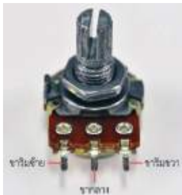
ภาพที่ 4 ตัวต้านทานแปรค่าได้และสัญลักษณ์ในวงจรไฟฟ้า
