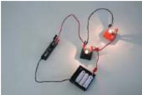
ภาพที่ 3 การต่อวงจรไฟฟ้าแบบขนานและการเขียนแผนภาพวงจรไฟฟ้าแบบขนานด้วยสัญลักษณ์ในวงจรไฟฟ้า
