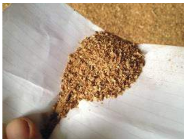
ภาพที่ 9 ตัวอย่างชีวมวลที่เป็นชี้เลื่อยจากไม้ยางพาราหรือไม้เบญจพรรณ ที่มา : กรมพัฒนาพลังงานทดแทนและอนุรักษ์พลังงาน
