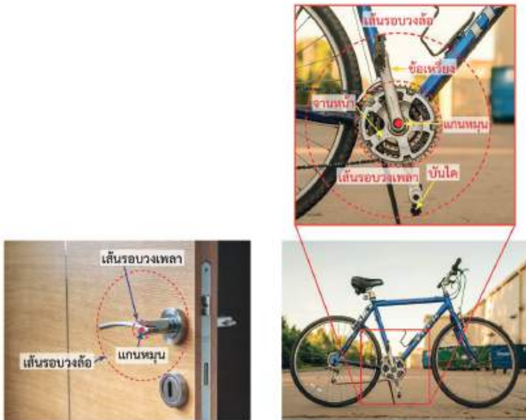
ภาพที่ 8 ตัวอย่างการใช้ล้อและเพลลาที่พบในชีวิตประจำวัน
