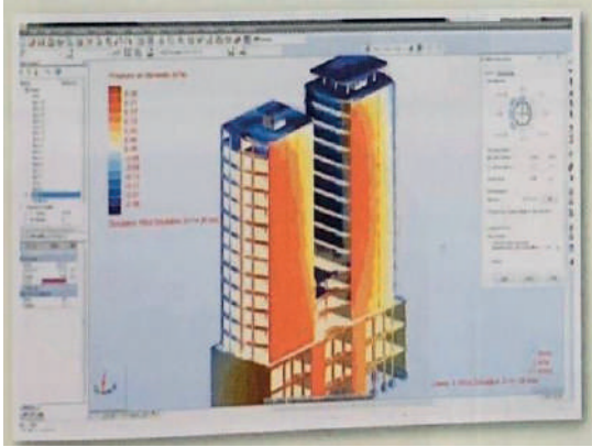
แบบจำลองทางคอมพิวเตอร์ ทดสอบการทนต่อแรงลมของอาคาร
