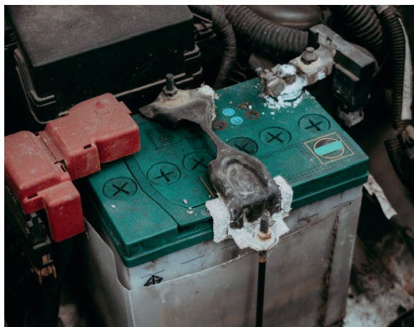
ภาพที่ 3 การกัดกร่อนตะกั่วเนื่องจากกรดซัลฟิวริกในแบตเตอรี่
