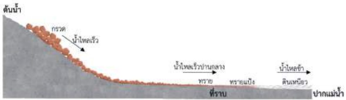
ภาพที่ 3 การกร่อนและการสะสมตัวของตะกอนในช่วงต่าง ๆ ของธารน้ำหรือแม่น้ำ
