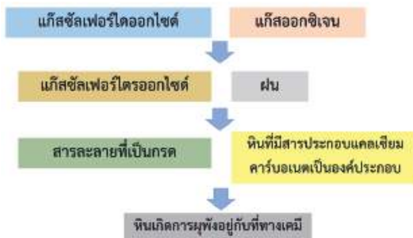
ภาพที่ 3 แสดงกระบวนการผุพังอยู่กับที่ทางเคมีของหินจากแก๊สซัลเฟอร์ไดออกไซด์ในอากาศ
