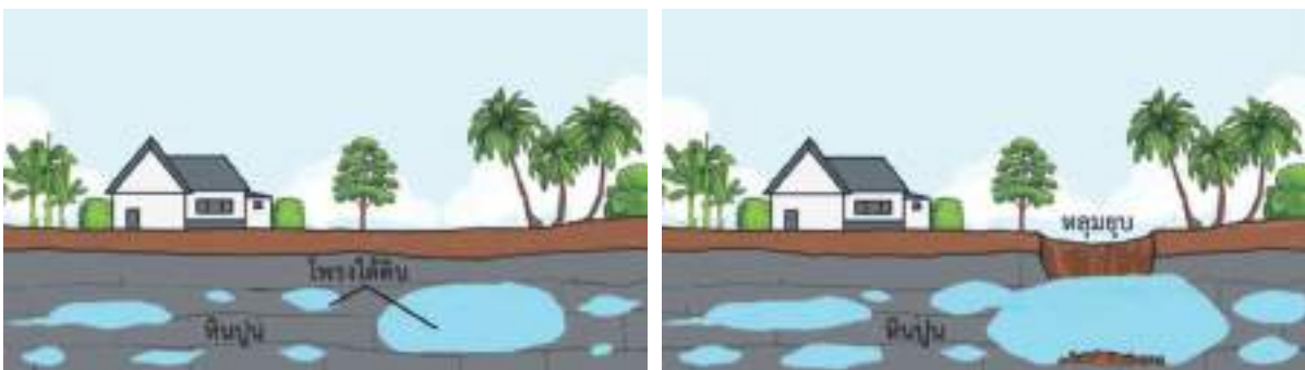
ก. ลักษณะของหินปูนที่กร่อนลงไปเป็นโพรงหรือถ้ำใต้ดิน
