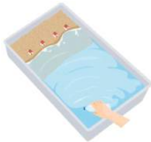
การจำลองคลื่นโดยกดขวดน้ำในแนวตั้งและปล่อย
