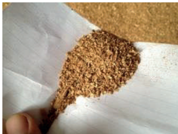
ภาพที่ 9 ตัวอย่างชีวมวลที่เป็นขี้เลื่อยจากไม้ยางพาราหรือไม้เบญจพรรณ ที่มา : กรมพัฒนาพลังงานทดแทนและอนุรักษ์พลังงาน
