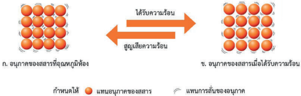
ภาพที่ 1 แบบจำลองอนุภาคการขยายหรือหดตัวของสสารในสถานะของแข็ง
