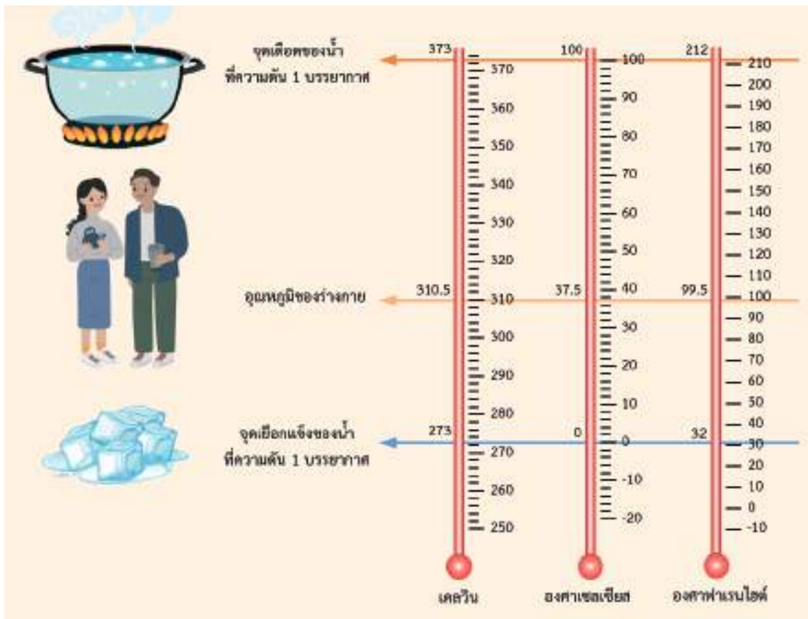
ภาพที่ 3 จุดเยือกแข็ง จุดเดือดของน้ำ และอุณหภูมิของร่างกาย
