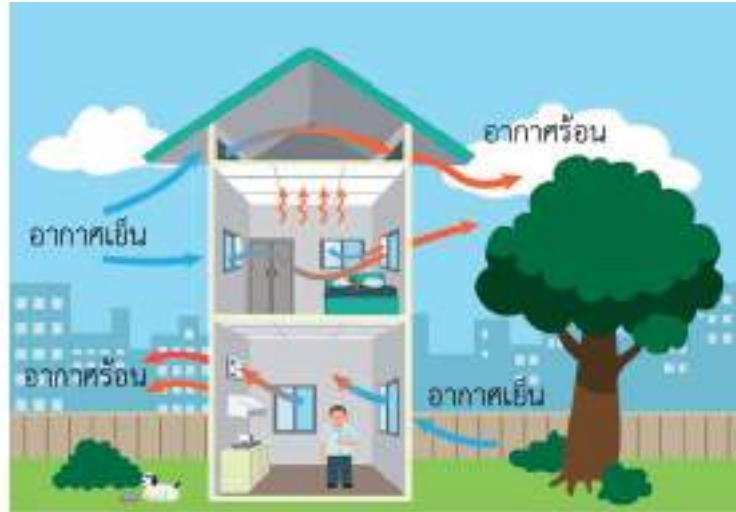
ภาพที่ 2 การออกแบบระบบระบายอากาศภายในอาคาร อากาศเย็นจากภายนอกที่เคลื่อนที่เข้ามาในอาคารจะได้รับความร้อนแล้วพาความร้อนออกไป โดยลูกศรสีส้มแทนอากาศที่มีอุณหภูมิสูง ลูกศรสีฟ้าแทนอากาศที่มีอุณหภูมิต่ำ
