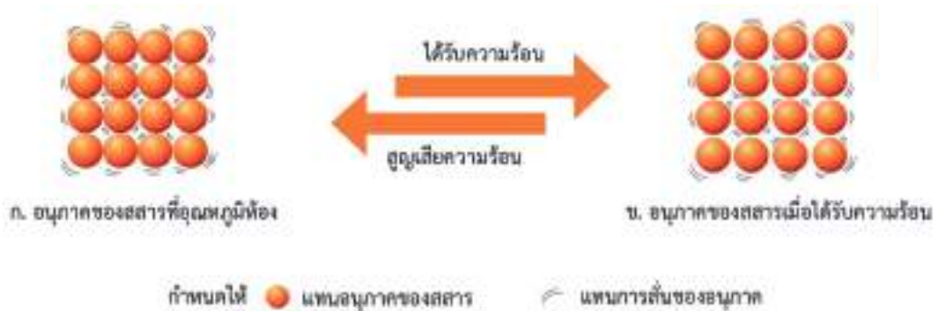
ภาพที่ 1 แบบจำลองอนุภาคการขยายหรือหดตัวของสสารในสถานะของแข็ง
