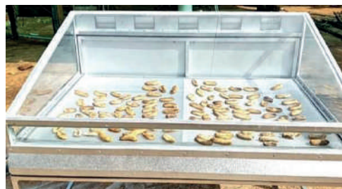
รูป 3 ตู้อบพลังงานแสงอาทิตย์ ทำให้สามารถเพิ่มระยะเวลาในการเก็บ และเพิ่มมูลค่าให้กับสินค้าทางการเกษตร
