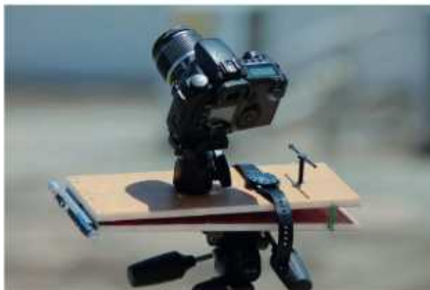
ภาพที่ 19 ลักษณะการติดตั้งกล้องดิจิทัลสำหรับถ่ายภาพวัตถุท้องฟ้า
