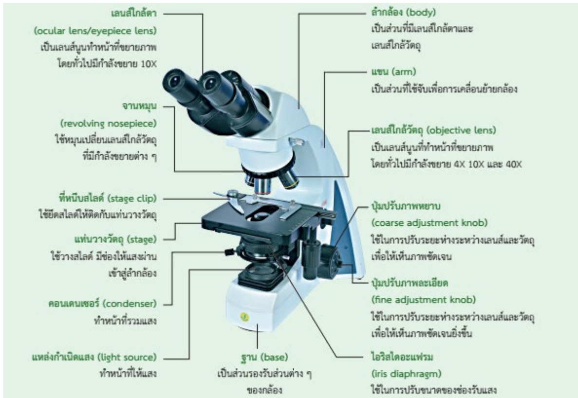
ภาพที่ 1 ส่วนประกอบของกล้องจุลทรรศน์ใช้แสง
